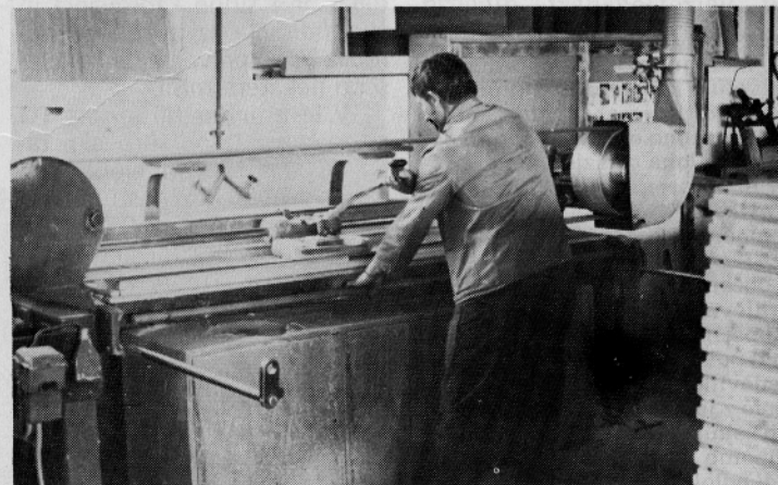
Zgodi se tudi, da je treba na tračni brusilki ročno obrusiti površino na vhodnih in garažnih vratih.
