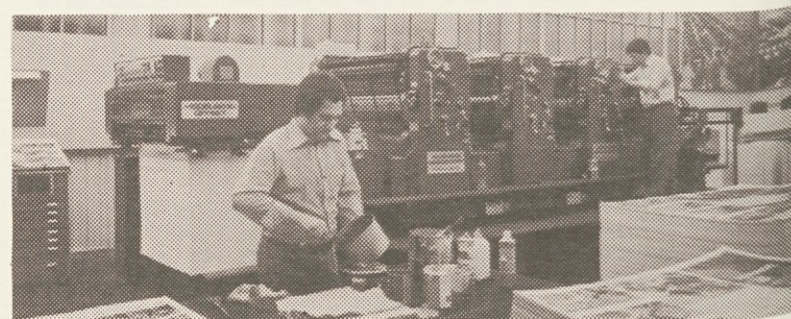
Štiribarvni ofsetni stroj Heidelberg speedmaster za tisk v štirih barvah po eni strani ali pa po dve barvi po obeh straneh. Zmogljivost do 10.000 izvodov na uro.
