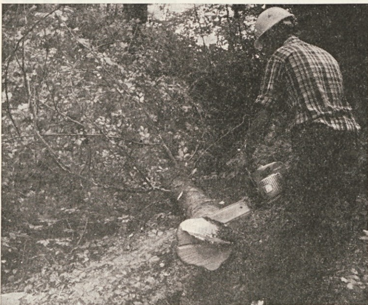
Delavec pri delu ne uporablja antivibracijskih rokavic in antifonov (zaščita sluha)
