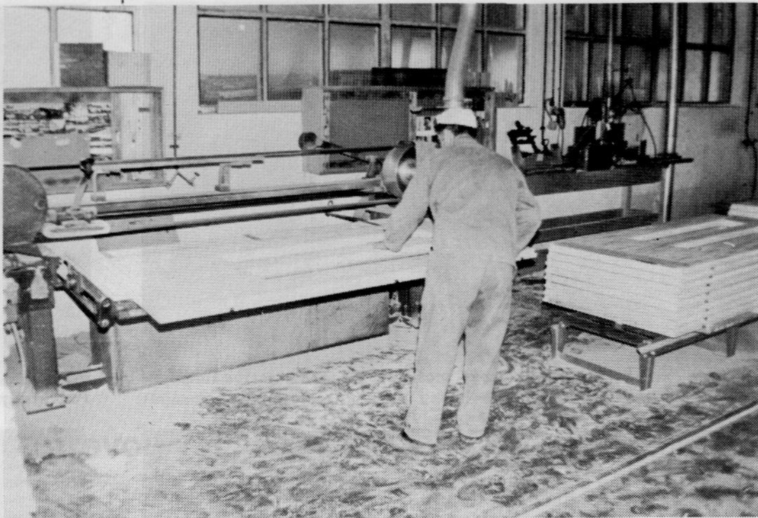
Včasih se zgodi, da je treba vhodna in garažna vrata pobrusiti tudi ročno na tračni brusilki — tržišče je namreč vsak dan zahtevnejše
