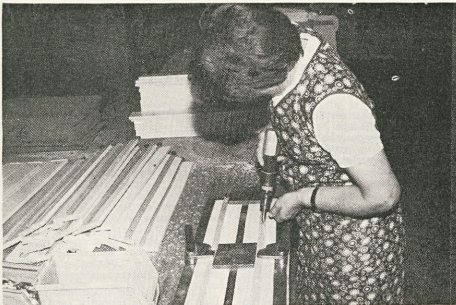
Sestavljanje pohištva se začne v predmontaži, kjer je predvsem žensko delo. Delavka privija kovinske iztege na stranice, ki so sestavni deli predala v omarici pisalne mize.
