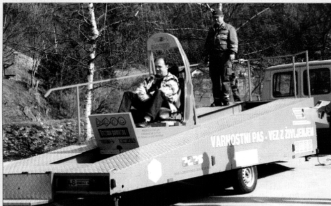
Z zaletavčkom so prikazali učinke trka pri hitrosti 50 km/h (foto: Ciril M. Sem)
