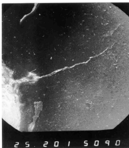
Sl. 5. Razpoka na površini ob oznaki na polju 1; EM; 200-kratna povečava
