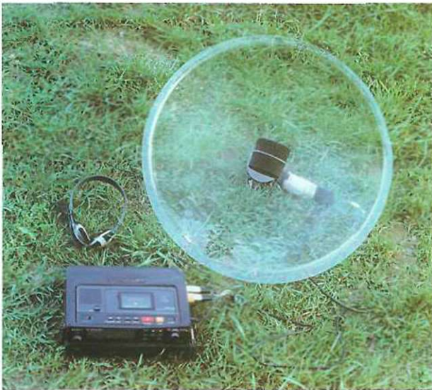
slika 1: Parabolni mikrofoni Telenga Pro 5 S in digitalni kasetofon Sony TCD-D10 Pro II - oprema, ki jo avtor prispevka uporablja za snemanje ptičjih zvokov.
