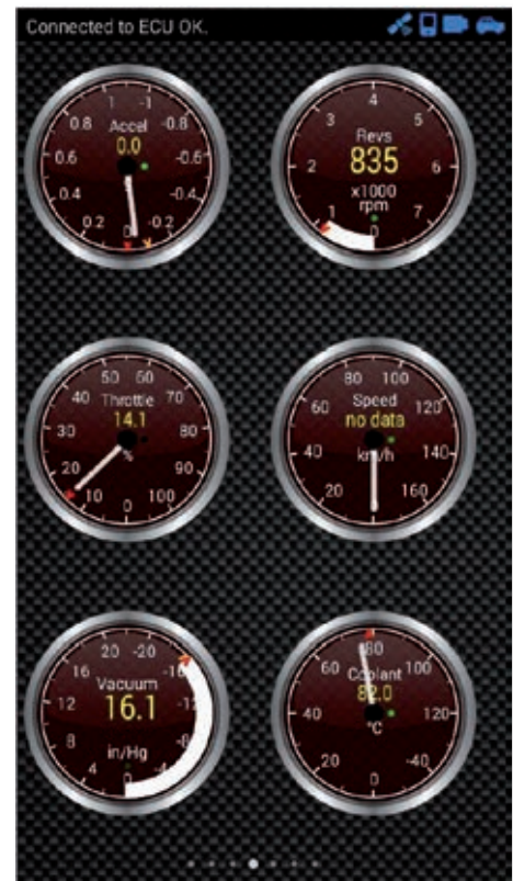
△ Prikaz navideznih analognih instrumentov na zaslonu pametnega telefona (Torque).
