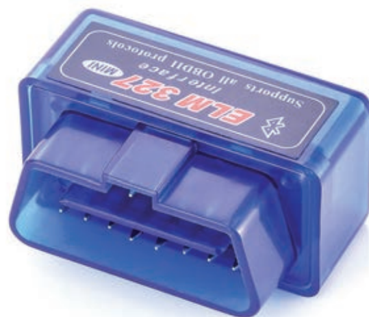
△ Vmesnik OBDII ELM327 Mini, ki se z računalnikom ali s pametnim telefonom poveže prek bluetootha.
