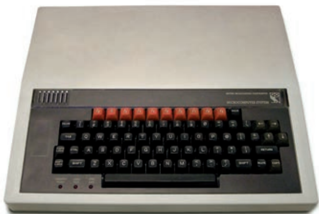
△ Računalnik podjetja Acorn BBC Micro je uporabljal centralno procesno enoto 6502, 8-bitni mikroprocesor, ki je poganjal tudi izdelke podjetij Apple, Atari, Commodore in drugih.
