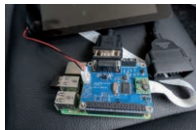
△ Doma izdelana naprava za avtomobilsko diagnostiko.
