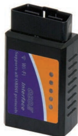
△ Univerzalni vmesnik OBD II, ki se z računalnikom ali s pametnim telefonom poveže prek Wi-Fi. Deluje v operacijskih sistemih Windows, Android in iOS.
