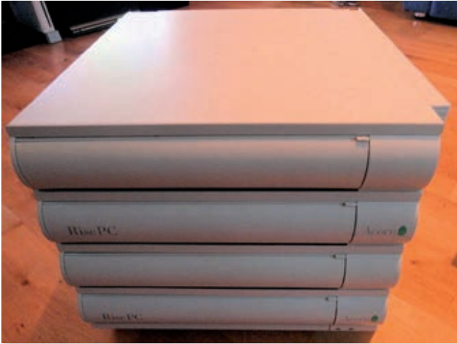
△ RiscPC je bilo mogoče nadgraditi z dodatnimi rezinami, ki so skupaj tvorile enotno ohišje.
