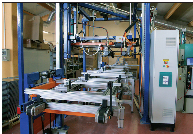
Slika 5. Paletni sistem s sistemom za hladno spajanje robov
