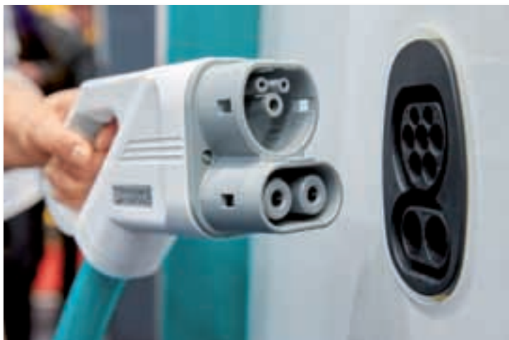
▽ CCS Combo2 temelji na priključku Mennekes, ki nima kontaktov za izmenični tok, ima pa dodatna kontakta za visoke enosmerne tokove za hitro polnjenje (350 kW).
