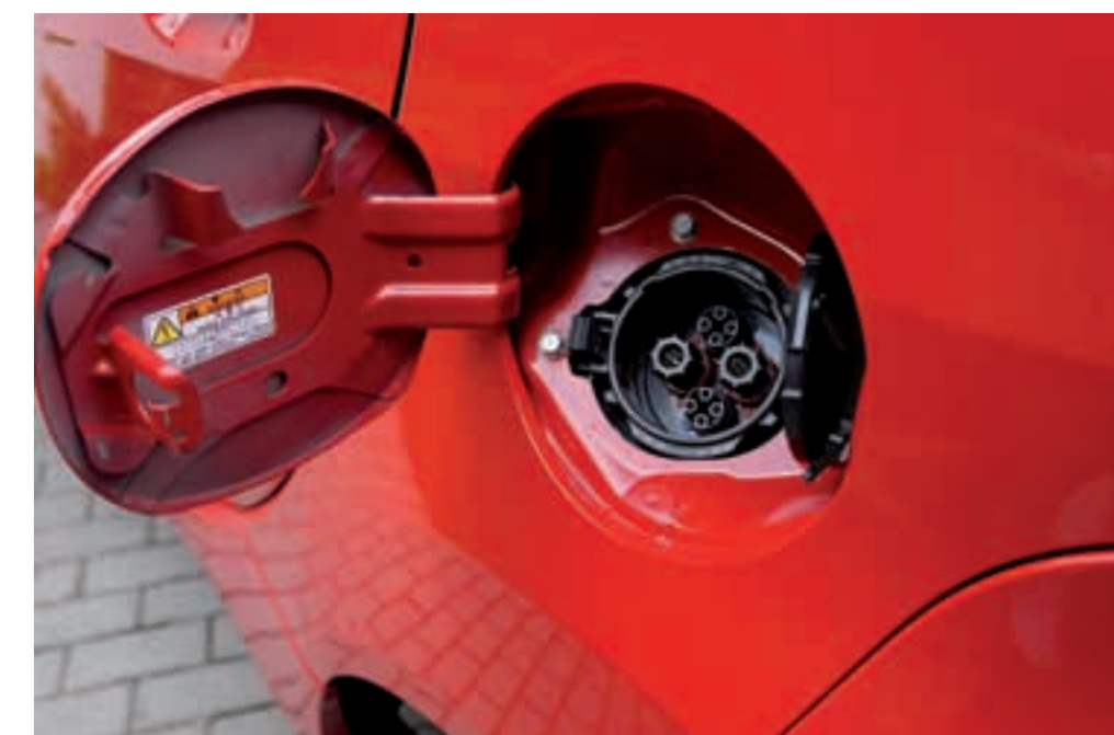
△ Japonski priključek CHAdemo najdemo na vozilih azijskih izdelovalcev.
