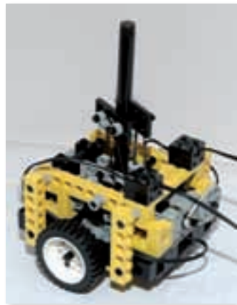
△ Robot-risalnik iz kock Lego Technic
