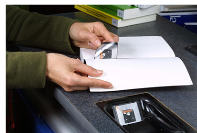
Slika 2: nameščanje 3M RFID nalepk
