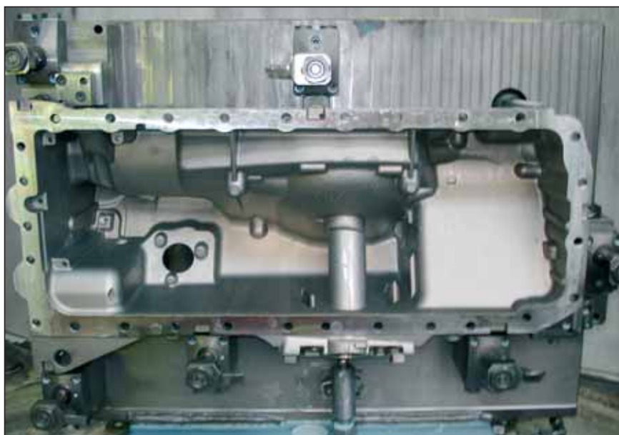
Slika 1. Obdelovanec – "karter" BMW X-drive v vpenjalni pripravi CNC-obdelovalnega centra (prvo vpetje)
