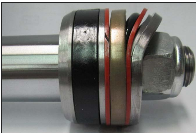
Slika 12. Poškodba bata na testiranem HV pri tlaku 600 bar
