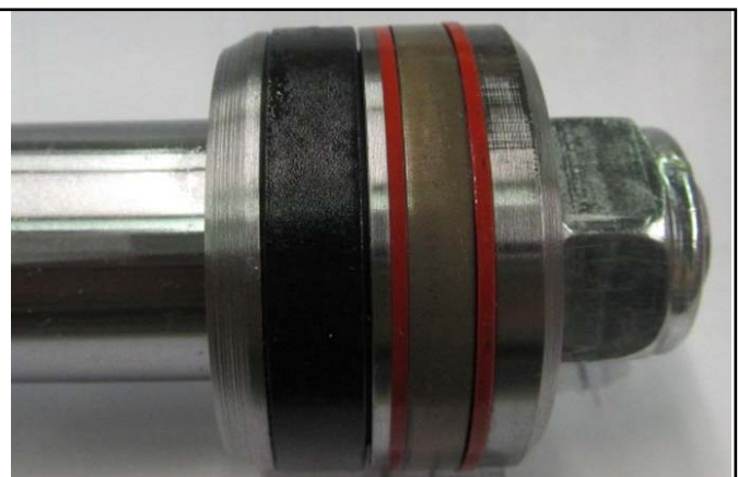
Slika 13. Modificirani bat, ki je prestal celotni visokotlačni test
