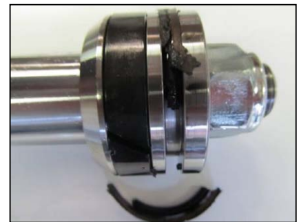
Slika 10. Strgano in izrabljeno poli-tetrafluor-etilensko tesnilo na batu testiranega HV po demontaži, po 37,4 km opravljeni poti (konfiguracija št. 3)
