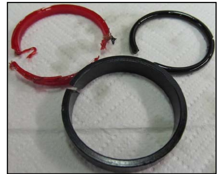
Slika 9. Izrabljeno in pretrgano poliuretansko tesnilo bata, drsni obroč brez deformacij že po 12 km dolžine opravljenih gibov batnice (konfiguracija št. 1)
