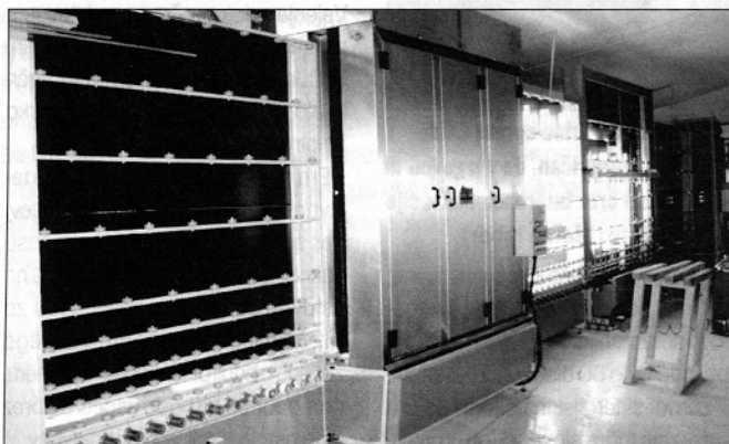
Nova avtomatska linija za izdelavo izolacijskega stekla (foto: KF)
