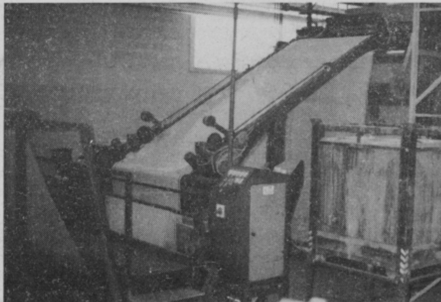
Del sušilnika v novem obratu tozda Opekarne Loče zreškega Cometa. Za uresničitev te naložbe in projekta sušilnika oziroma impregnacijske naprave za oplemenitenje steklene tkanine, je skupina Cometovih tehnologov in raziskovalcev prejela tudi občinsko nagrado INOVATOR 79.
