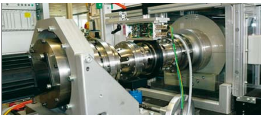
Slika 1. Kalibriranje navora na delu pogonske gredi v kalibracijskem laboratoriju
