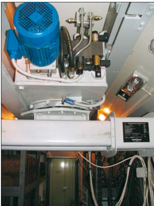
Hidravlični agregat prevoznega teleskopskega dvigala (detalj)
