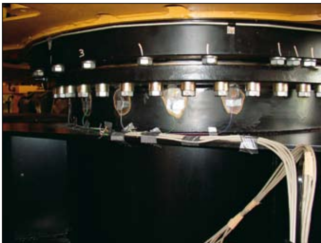
Meritve z merilnimi lističi na podvozu bagerja
