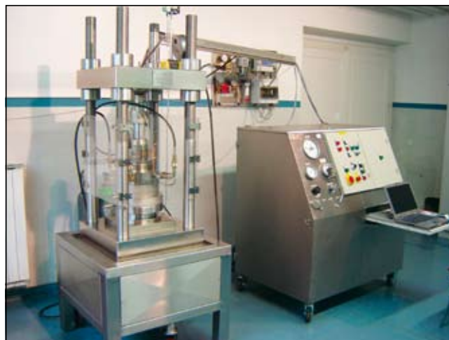
Elektronsko vodena stiskalnica za preizkušanje mehanskih lastnosti kamnin
