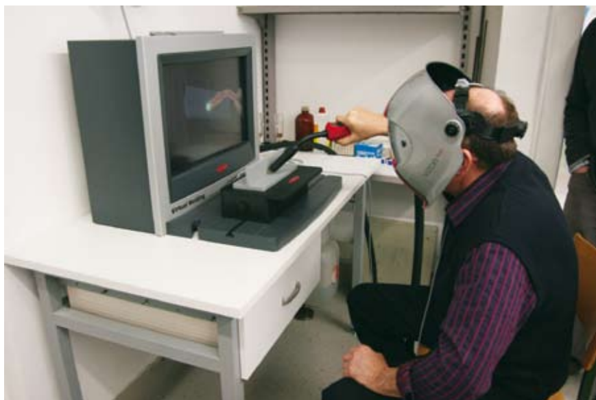
Slika 4. Varilni simulator za učenje obločnega varjenja
