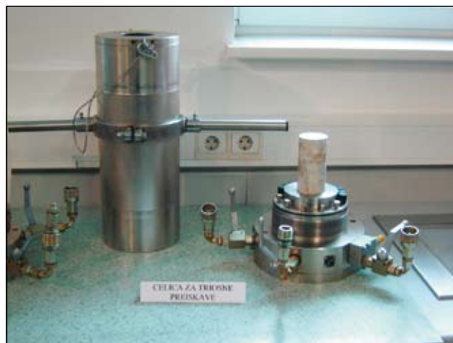
Triosna celica za preizkušanje trdnostnih in deformabilnostnih lastnosti kamnin pri vsestranskih tlakih do 25 MPa
