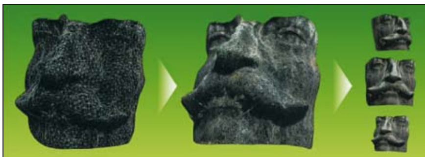
Slika 4. Oblak točk povežemo s trikotniki (levo) in opremimo s teksturami (v sredini)
