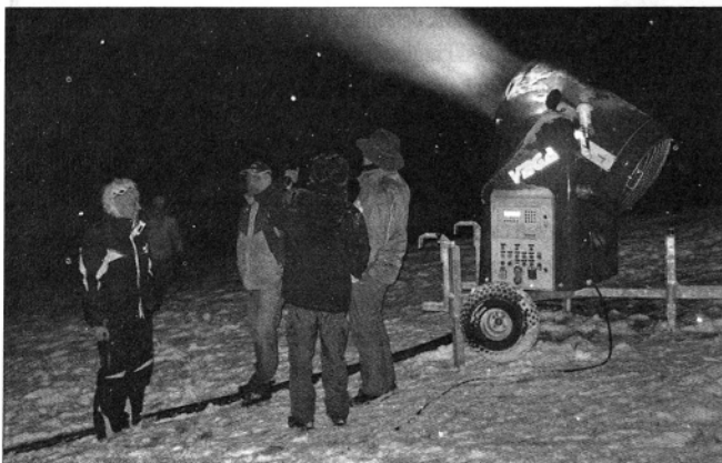
Snežni top sam dozira količino snega glede na zunanjo vlago in temperaturo (foto: BR)
