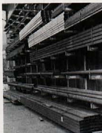
Urejeno skladiščenje železnih profilov
