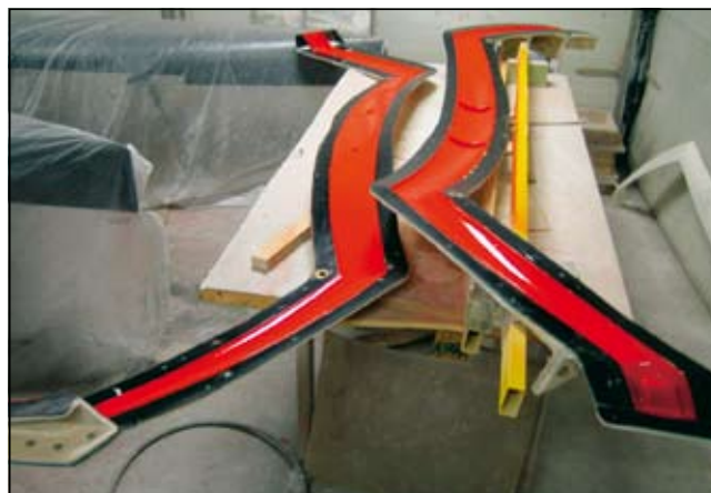
Slika 6. Priprava kalupov za prečko
