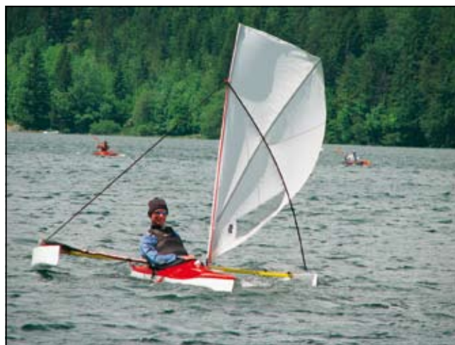
Slika 2. Trimaranska prototipna izvedba jadralnega kajaka
