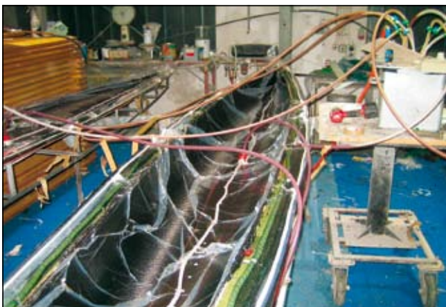
Slika 5. Vakuumška infuzija glavnega trupa
