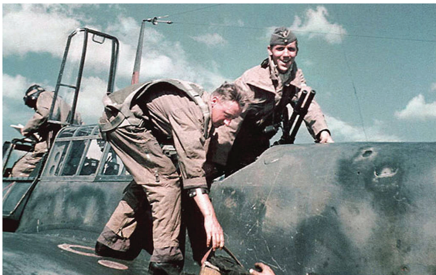
Bf 110 z naknadno vgrajeno dvocevno strojnico MG 81Z
