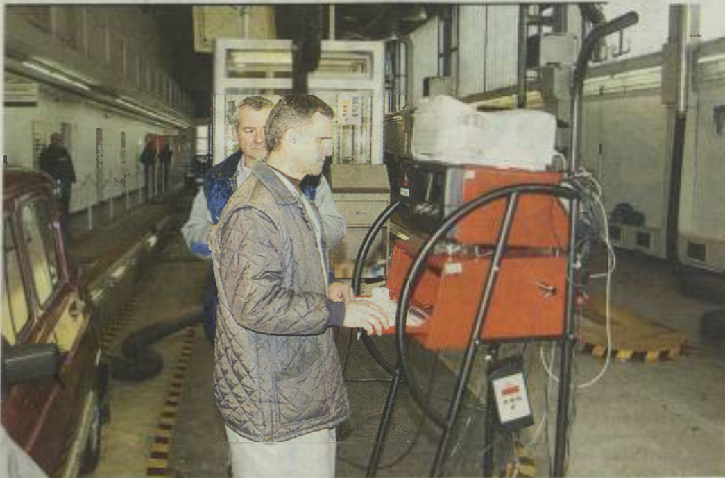
V merilno napravo pred meritvijo vnesejo identifikacijske podatke o vozilu, in sicer: registrska oznaka, znamka vozila in tip vozila. Ob koncu pregleda vam izpišejo podatke prek tiskalnika. Izpiše se tudi ocena uspešnosti preizkusa merjenja emisije izpušnih plinov (preizkus uspešen/neuspešen).
