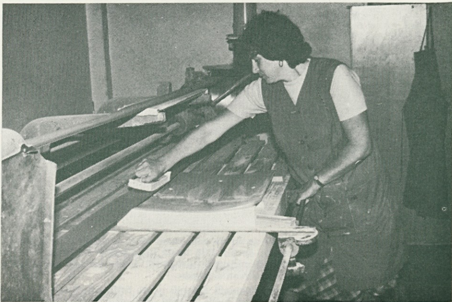
Marinka iz neserijske je izkušena brusilka na pasnem brusilnem stroju. Ko je nastal ta posnetek, je brusila zakrivljene furnirske naslone.
