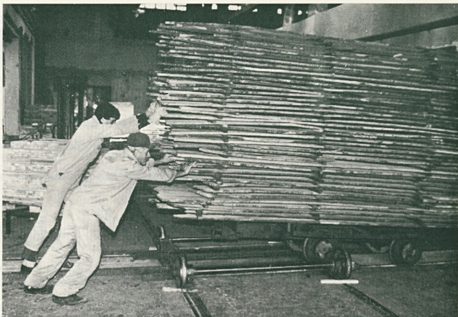
Transport desk in plohov pred sušilnicami lesa je zastarel in počasen. Na vagončke naložen les prevažamo ročno.
