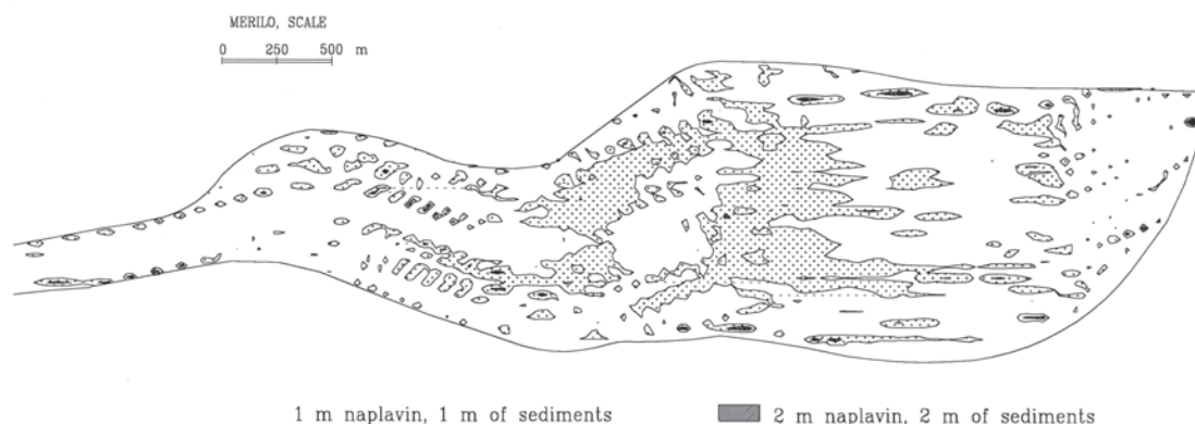
Sl. 4. Višina usedlih lebdečih plavin v Ptujem jezeru v obdobju od 1981 do 1991 Fig. 4. Sediment height in Ptuj lake during the period from 1981 to 1991
