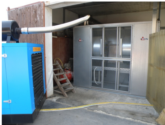
Peč Wolf HL 10 s predogretim zrakom iz elektro generatorja. (foto D. Vrhovnik)
