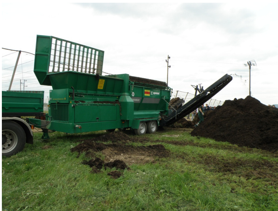
Na predstavitvi stroja za ločevanje vrvice od hmeljevine v kompostu (6. maj 2009), so se udeleženci strinjali, da stroj odlično opravi svojo nalogo. (foto: D. Vrhovnik)
