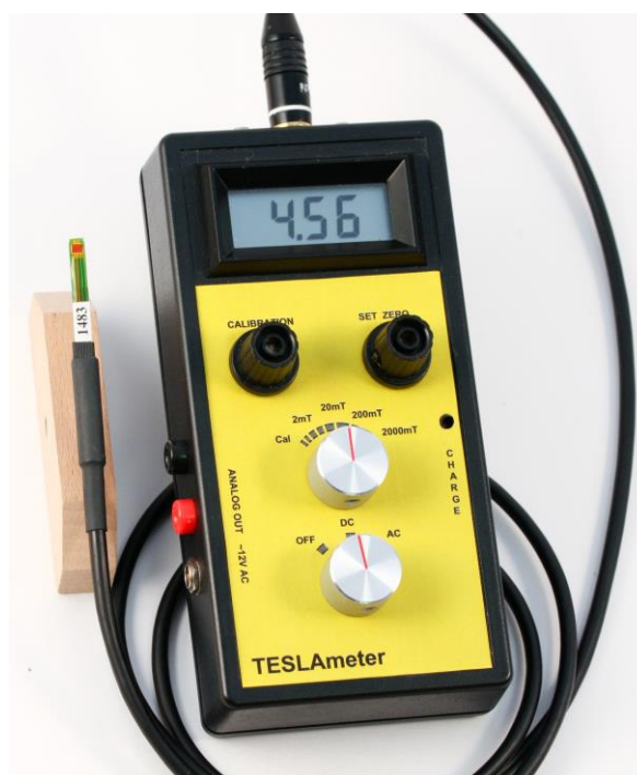
Slika 4: Teslameter-merilnik s priključeno sondo. Na levi strani je viden priklop za voltmeter.
