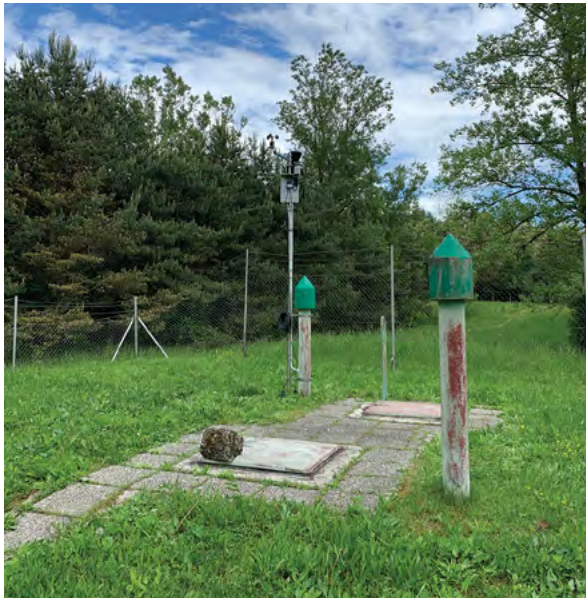
Slika 3: Postaja za spremljanje vsebnosti nitratov v podzemni vodi Skorba V-2.
