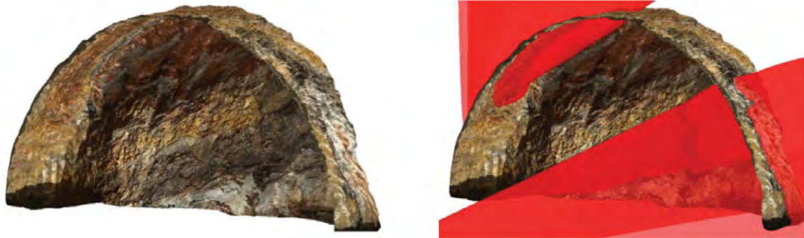
Slika 6: Fotogrametrični model izkopa kalote vzhodne cevi pri predorskem metru 637 z vrisanimi geološkimi strukturami in brez njih.
