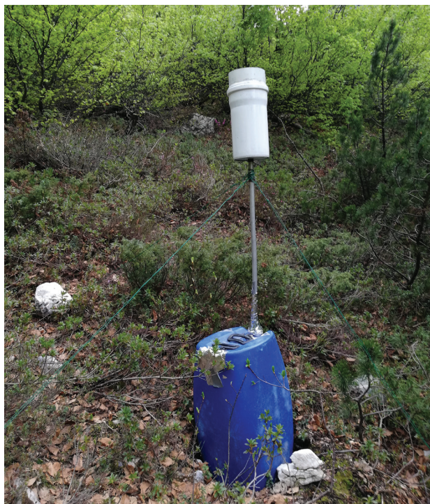
Slika 2. Dežemer z lijem in lovilno posodo, ki ju med seboj povezuje ozka cev (foto: M. Ogrin).
