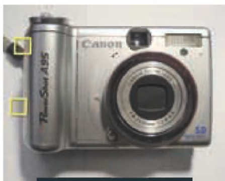
Razdiranje: digitalni fotoaparat Canon PowerShot A95. Najprej odstranimo baterijo, odvijemo 2 vijaka s strani ...
