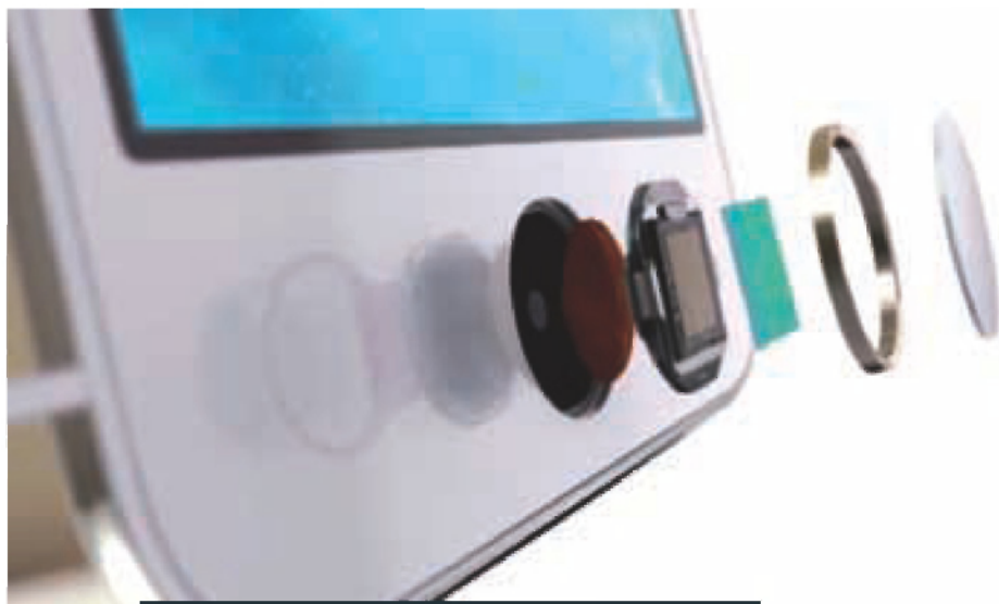
Applov bralnik prstnih odtisov sestavljajo (z desne): kristal safirja, jekleni obroč, lepilo, kapacitivni detektor.
