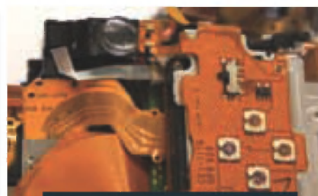
Elektronska vezja znotraj digitalnega fotoaparata so tako na miniaturnih ploščicah tiskanih vezij kot na plastičnih trakovih. Slednje je skoraj nemogoče popravljati.
