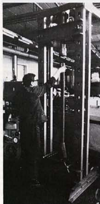
Hidr. preša v kovinski delavnici — nabijanje puš za bradlje
