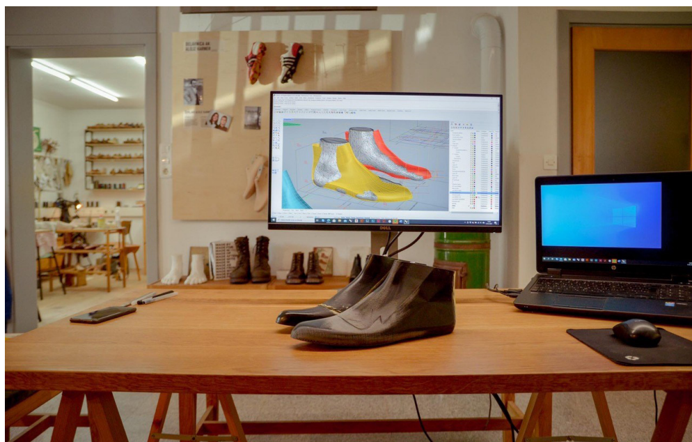
Fotografija 3: Individualno prilagojena in računalniško oblikovana kopita na podlagi 3D-posnetka (skena) stopal. Arhiv AK Alojz Karner, Žiri, 2021.
