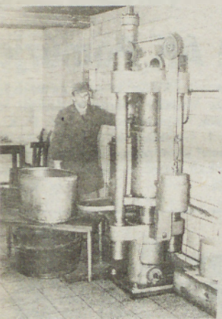
Spražena zmes »roma« v hidrav- lično stiskalnico. Le-ta je mo- čna, zato temu primeren izkori- stek: za liter olja je treba 2,7 ki- lograma semena.
