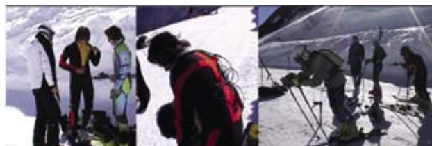
Slika 1: MVN obleka, ki se stoji iz 17 MTx senzorjev, ki jo je smučar oblekel pod tekmovalni kombinezon. RTK GNSS sprejemnik, shranjevalnik podatkov (Xbus master) in antena so spravljani v majhen nahrbtnik, ki ga nosi smučar.
