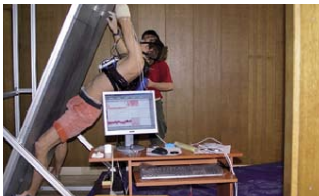
Slika 9. Nagibna stena s preiskovancem med testom. Naprava omogoča dovolj naporno testiranje športnih plezalcev, saj so ti zaradi majhne telesne mase, deloma pa tudi zaradi relativno velike moči mišic podlahti, sposobni premagovati precej velike nagibe med testom.
