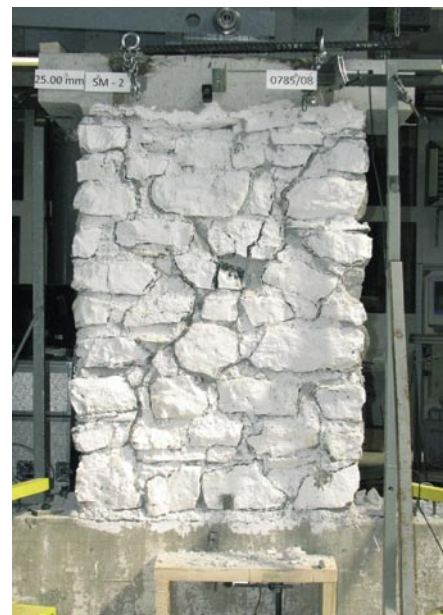
Slika 7 • Poškodbe referenčnega neutrjenega zidu pri končnem mejnem stanju
