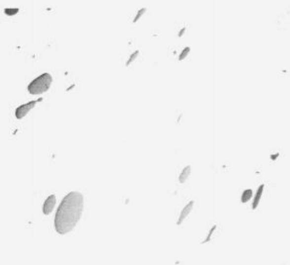
Slika 1. Vključki v avtomatnem jeklu (200 \times ).
