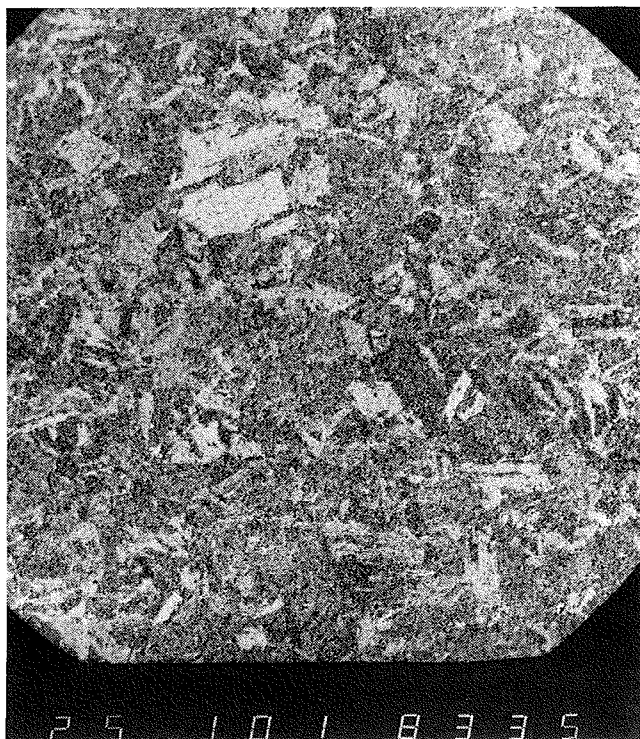
Slika 7: pov. 100x. Zlitina B. Posneto v SEM. Mikrostruktura po gašenju s temperature 1200°C.
