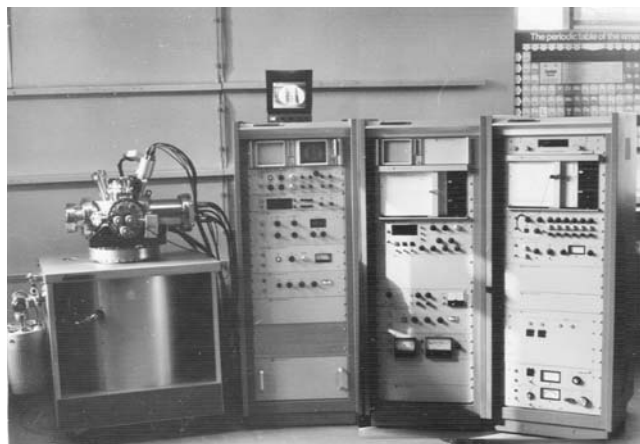
Slika 1: Vrstični analizator Augerjevih elektronov ameriškega podjetja Physical Electronics Ind., SAM, PHI Model 545A, instaliran na IEVT aprila 1977: vakuumsko posoda s spektrometrom (levo) in elektronika
