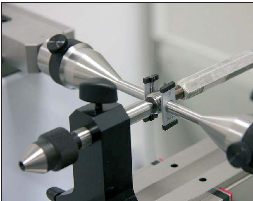
Kalibracija navojnega trna na visokozmogljivem linealnem stroju
