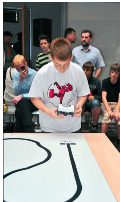
ROBOSled DIRKAČ: Tudi samogradni mobilni robot mora čim hitreje prepeljati od štarta do cilja po progi, označeni s črno črto.
