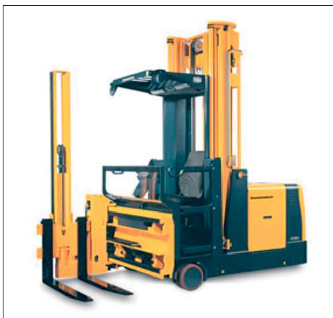
Slika 1. Viskoregalni elektro komisionirni tristranski viličar EKX proizvajalca Jungheinrich
