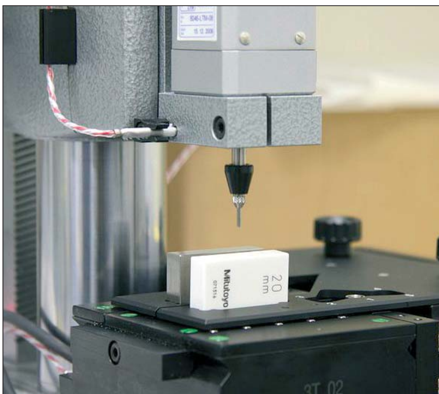
Kalibracija merilnih kladic na komparatorju
