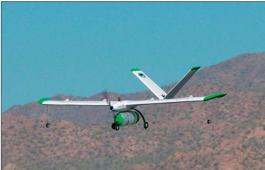
Slika 3. EDA100 s podtrupnim tovorom mase 4,81 kg pred pristankom
