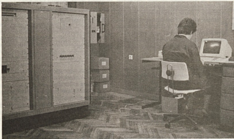
Prostor kemičnega laboratorija dodatno segreva še kvantometer, kar je ob visokih poletnih temperaturah popolnoma odveč. Prostor sicer »hladi« aircondition, kateremu pa uspeva ohlajevati zrak, v najboljšem primeru, le do +25°C.
