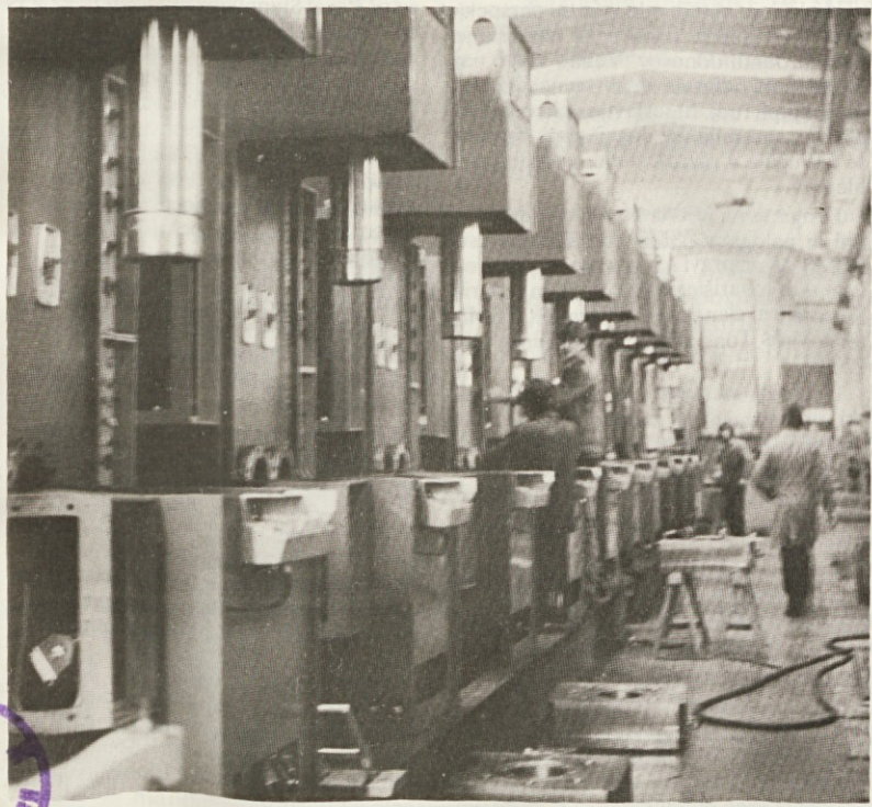
Montaža vlečnih strojev HVC-2-160
