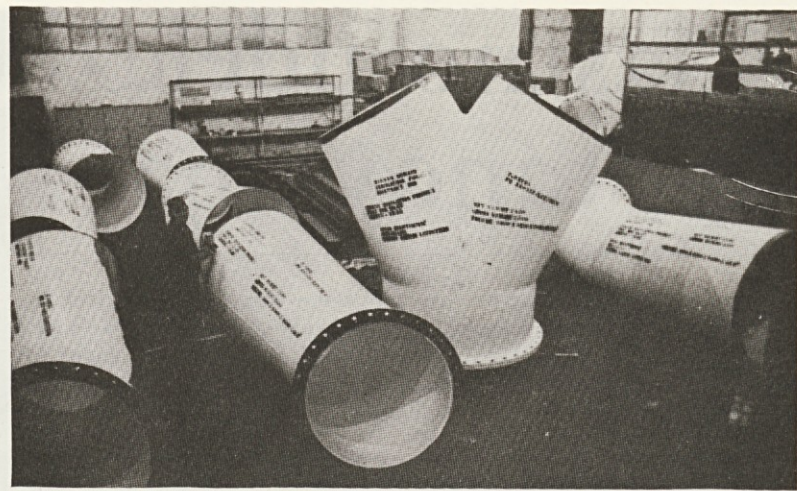
Deli hladnega cevovoda za črpalno postajo Kirkuk v Iraku.
