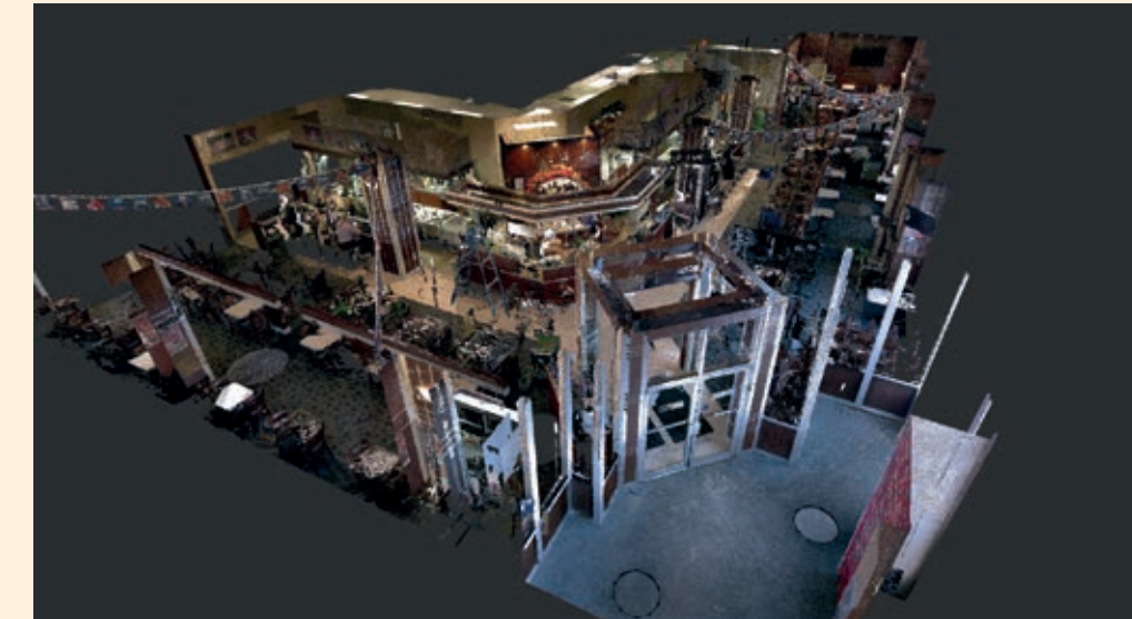
▲ Uporaba radarskih skenerjev Lidar omogoča zajemanje zgradb v 3D-oblaku točk, ki je nato osnova za vektorizacijo in pripravo načrtov.
