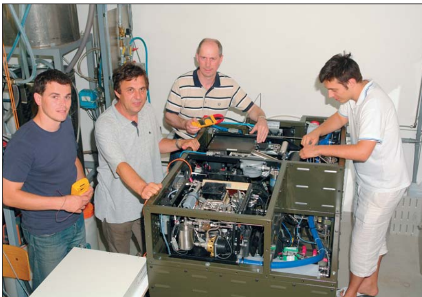
Preizkušanje 7-kilowatnega agregata z gorivnimi celicami
