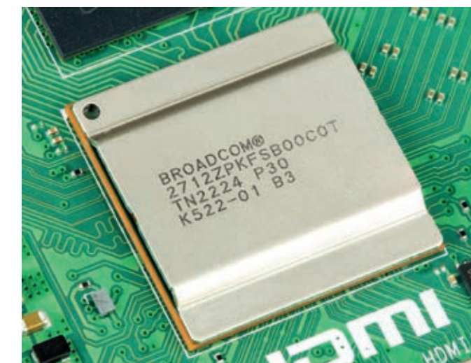
▲ Sistem v enem čipu BCM2712 s štirimi procesorskimi jedri ARM Cortex A76.
