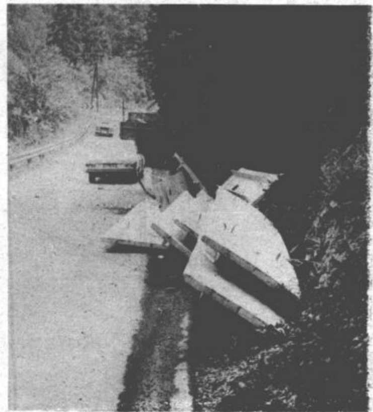
Posnetek smo napravili pred nedavnim na cesti med Penkom in vasjo Gorenje. Tovor je bil verjetno malomarno naložen ali pa je voznik tovornjaka prehitro zapeljal v ovinek. In težke cementne obloge so se znašle na tleh. Še sreča, da se ni v tistem trenutku srečal z nasprotni vozečim vozilom ali pa prehitel pešca oziroma kakšnega kolesarja.
