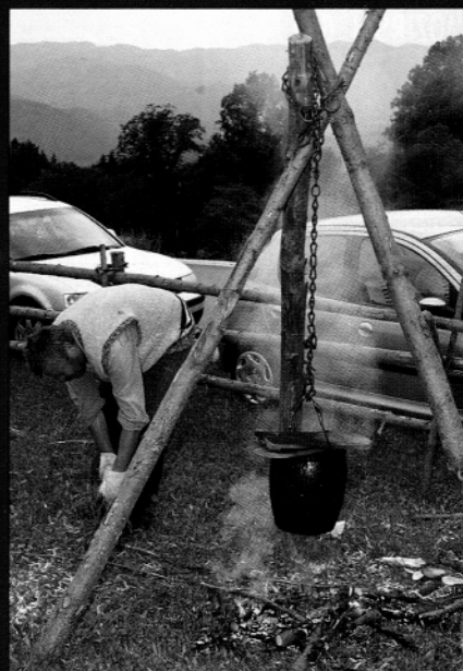
Pastir je poskrbel, da je smola v kotličku zavrela in da so se smrekove veje, segrete na ognju, lepo upogibale (foto: Benjamin Kanjir)
