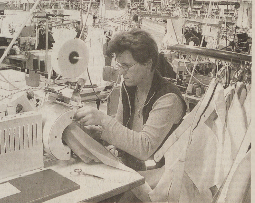
Z novim strojem za lepljenje traku po dolžini hlač je za to operacijo zdaj potreben le en delavec.
