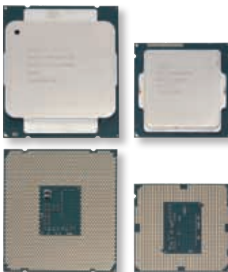
Procesorji s sredico Haswell-E (primer Core i7-5960X) so precej večji od procesorjev s sredico Haswell (primer Core i7-4770K).
