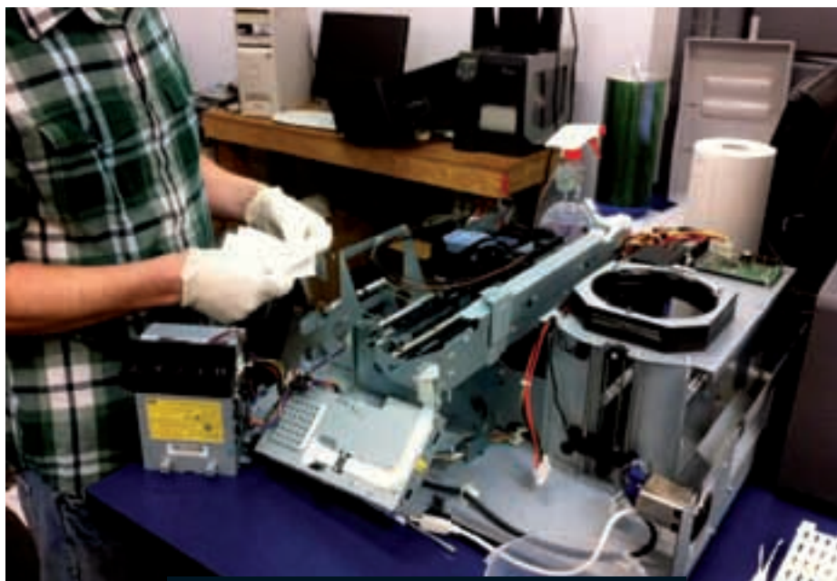
Tiskalnik med menjavo enega od elektronskih modulov
