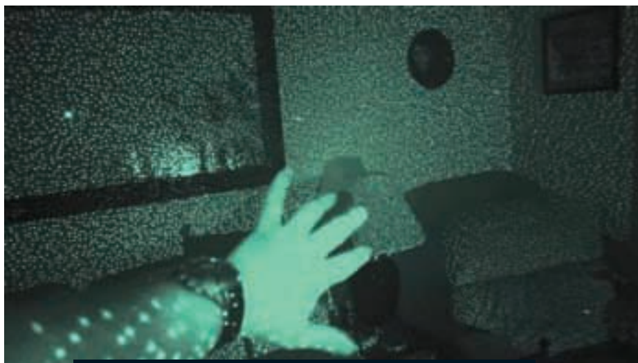
Kinect v okolico projicira IR vzorec pik, katerega deformacija na predmetih da informacijo o položaju v prostoru. Slika: Geospatial Modeling & Visualization, University of Arkansas.
