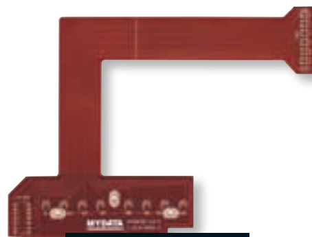
Upogljivo tiskano vezje, ki nadomešča kabel
