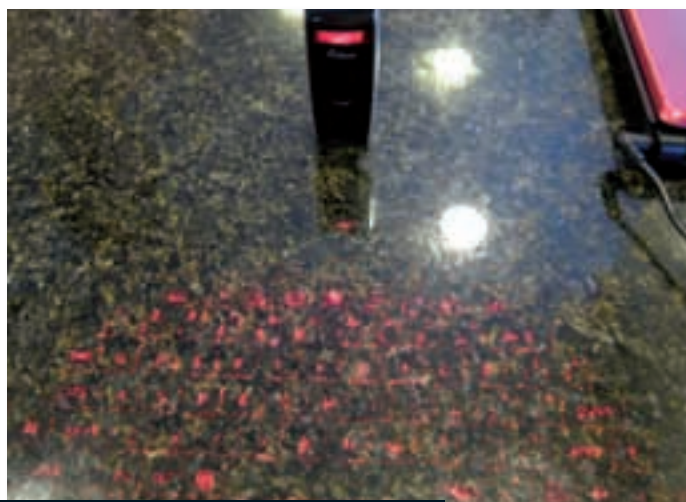
Laserske tipkovnice IR so na lisasti ali neravni podlagi neuporabne. Na fotografiji že precej star Cellulon LaserKey CL850 na lesu (levo) in granitu (desno). Slika: variableghz.com.
