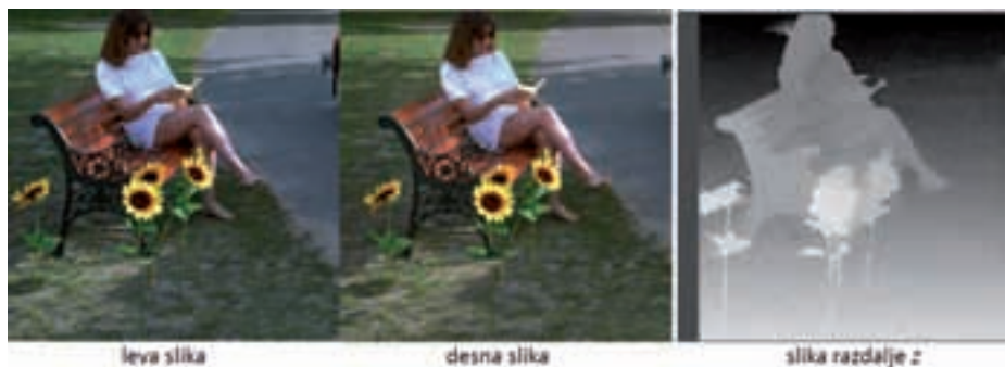
Pri stereo vidu isti prizor hkrati posnamemo z dvema kamerama z znanimi položajema. Razlike med slikama lahko preračunamo v razdaljo. Slika: Franjo Pernuš, Laboratorij za slikovne tehnologije, UL FE.
