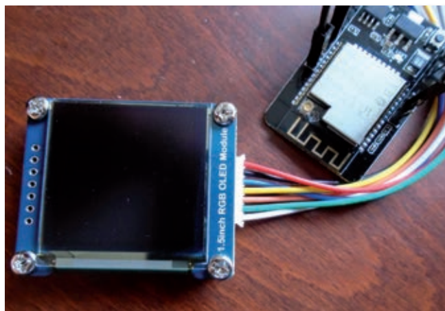
△ Prikaz povezovanja modulov z natičnimi kabli. Slika je simbolična. Dejanske povezave avtorji projektov označijo v načrtih.
