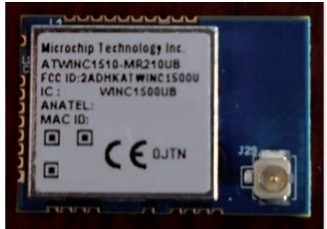
▲ Microchipov modul Wi-Fi Winc1510, združljiv z AWS IoT Core, ki ga najdemo na vse več razvojnih ploščah.
