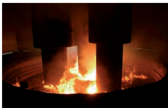
▽ Električna obločna peč za proizvodnjo silicija. Slika: Tenova
