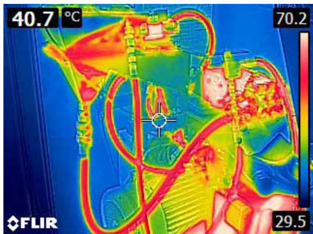
Slika 7 : Toplotne razmere na hidravličnem preizkuševališču med testiranjem
