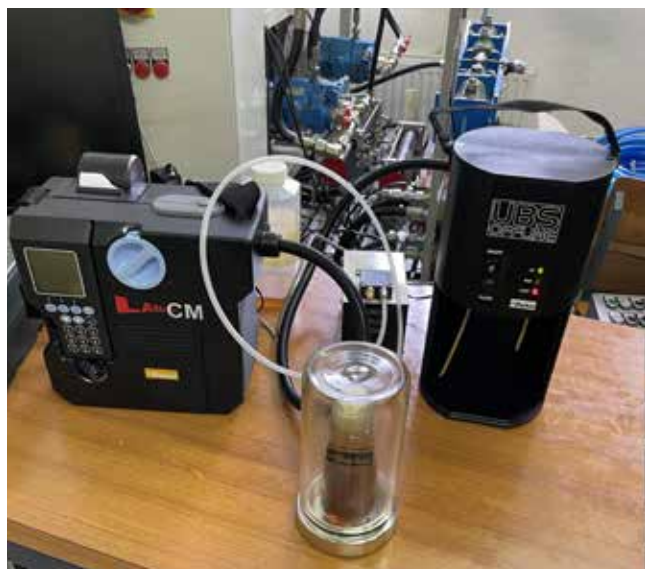
Slika 6 : Odstranjevanje zraka in meritev čistoče vzorca hidravličnega olja
